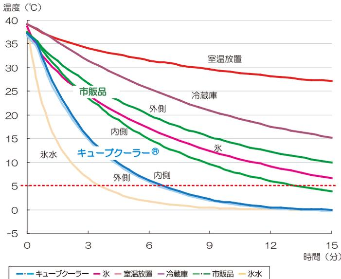
**キューブクーラー® は、採血管の挿入部位の違いによる温度差がなく、氷水に近い冷却速度を達成します**
