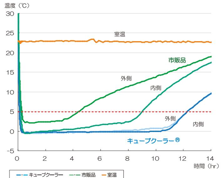
**キューブクーラー® は、採血管の挿入部位の違いによる温度差がなく、長時間保冷を実現します**
